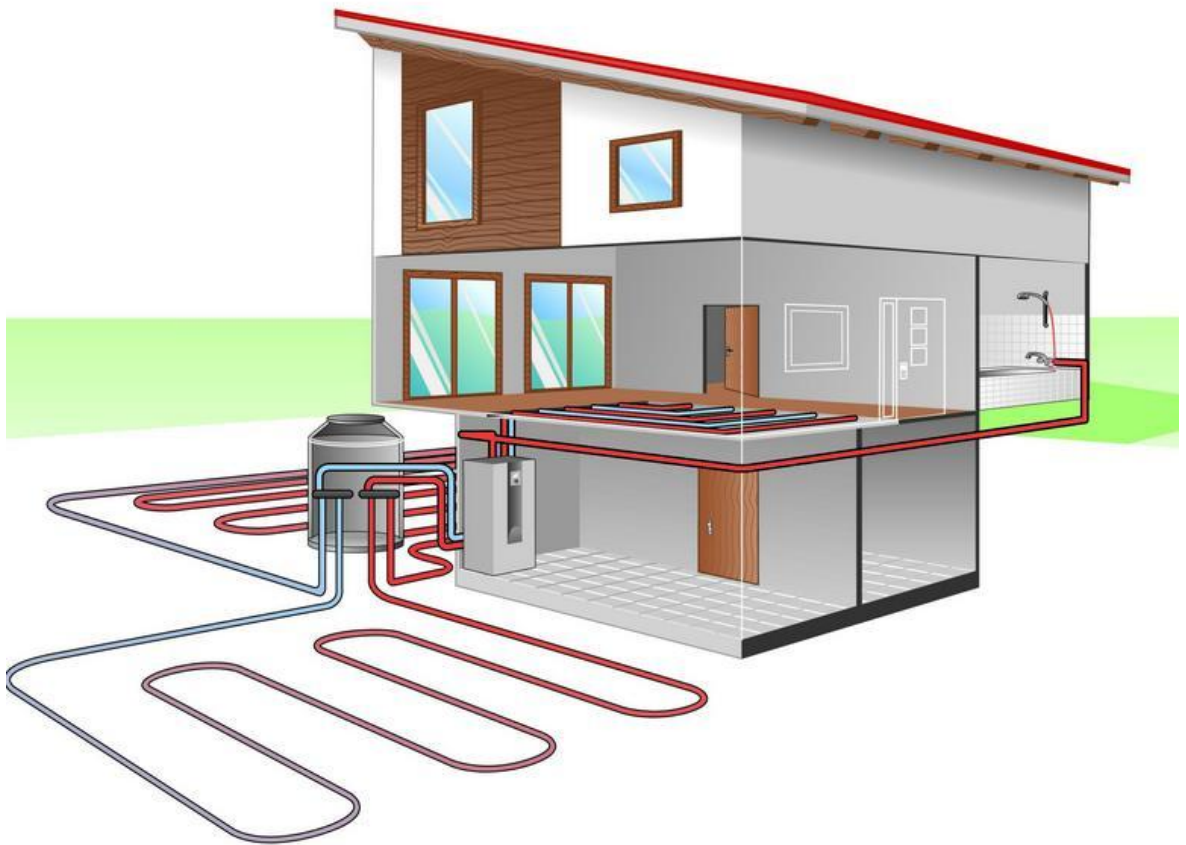
Kuvio 2. Maalämpöjärjestelmä. (Callidus, [viitattu 24.3.2014].)
