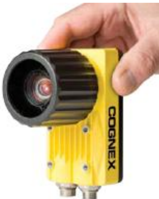
Kuva 17. Cognex in-Sight IS5403, 1600x1200 pikseliä. /12/
