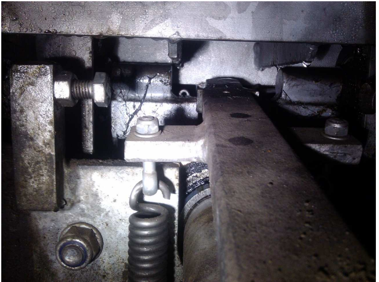
KUVA 8, Toimintakunnossa oleva asetelma, alkuperäisillä pulteilla
