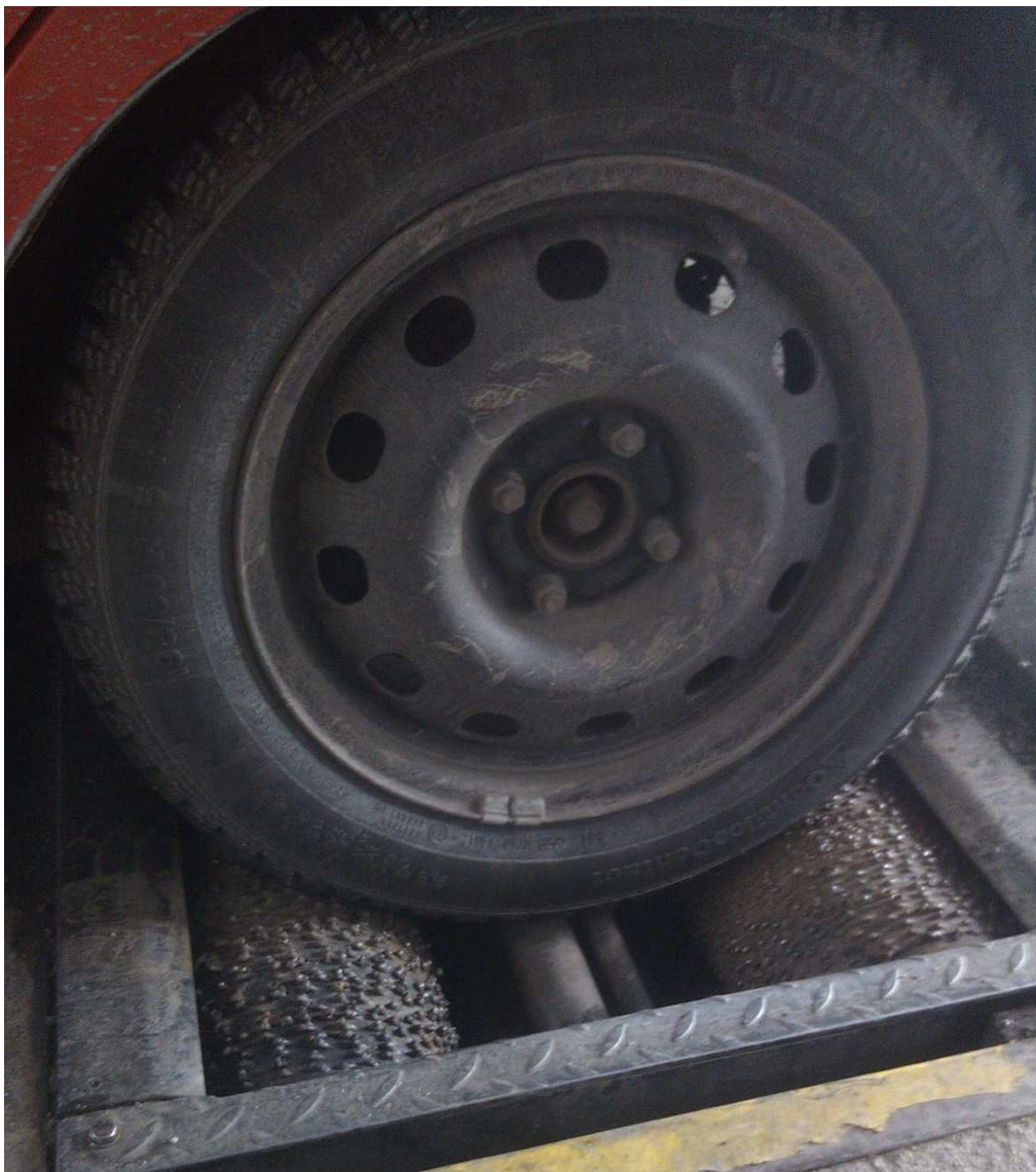
KUVA 9, Henkilöauton rengas dynamometrin teloilla.
