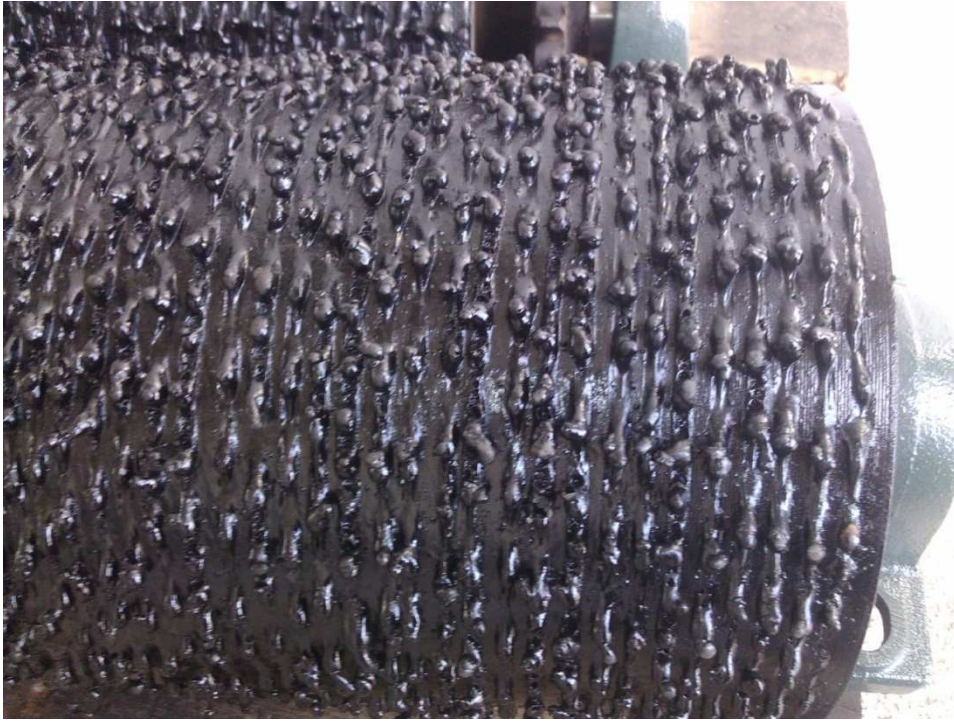
KUVA 14, Kunnostettu hitsipinnoitettu tela
