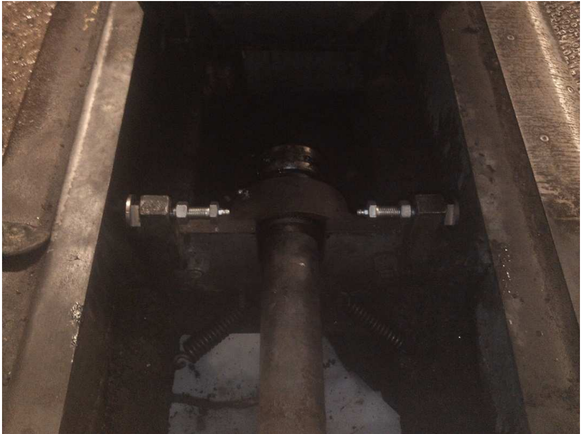
KUVA 7, Uudet pultit ja kulutuspalat kiinnitettynä runkoon
