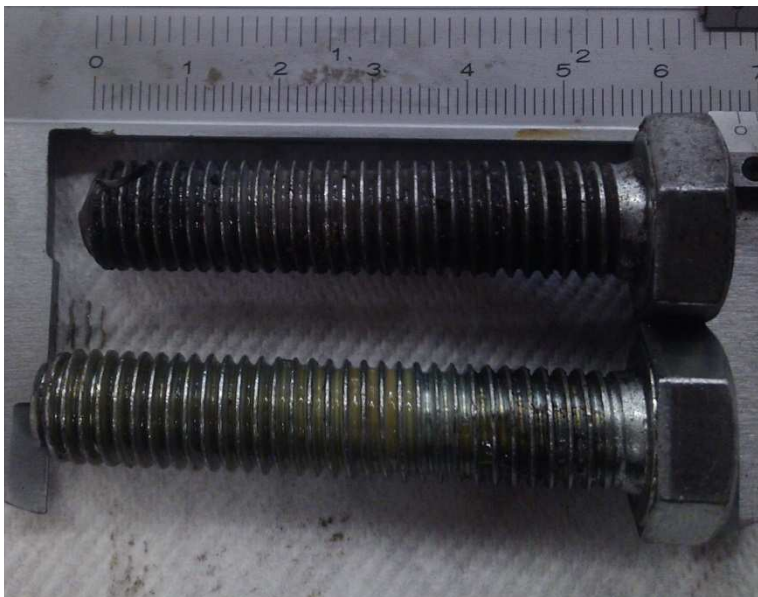
KUVA 4, Kulunut ja ehjä keskityspultti
