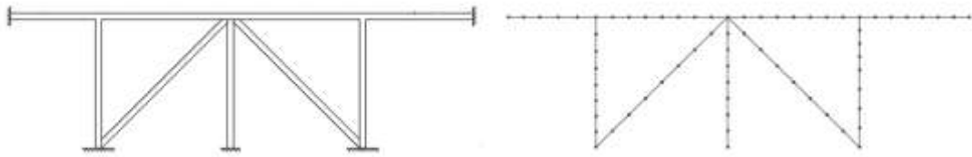
Kuva 25. Viivarakenne (Digma www-sivut. Viitattu 6.11.2013)
