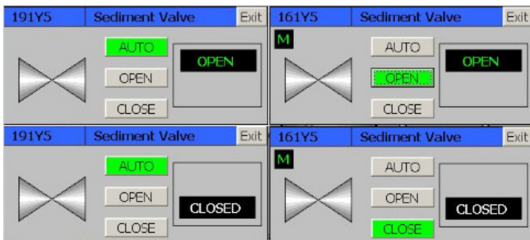
Kuvio 35. Venttiilien ohjausikkunat eri asentotiedoilla ja ohjaustavoilla.
