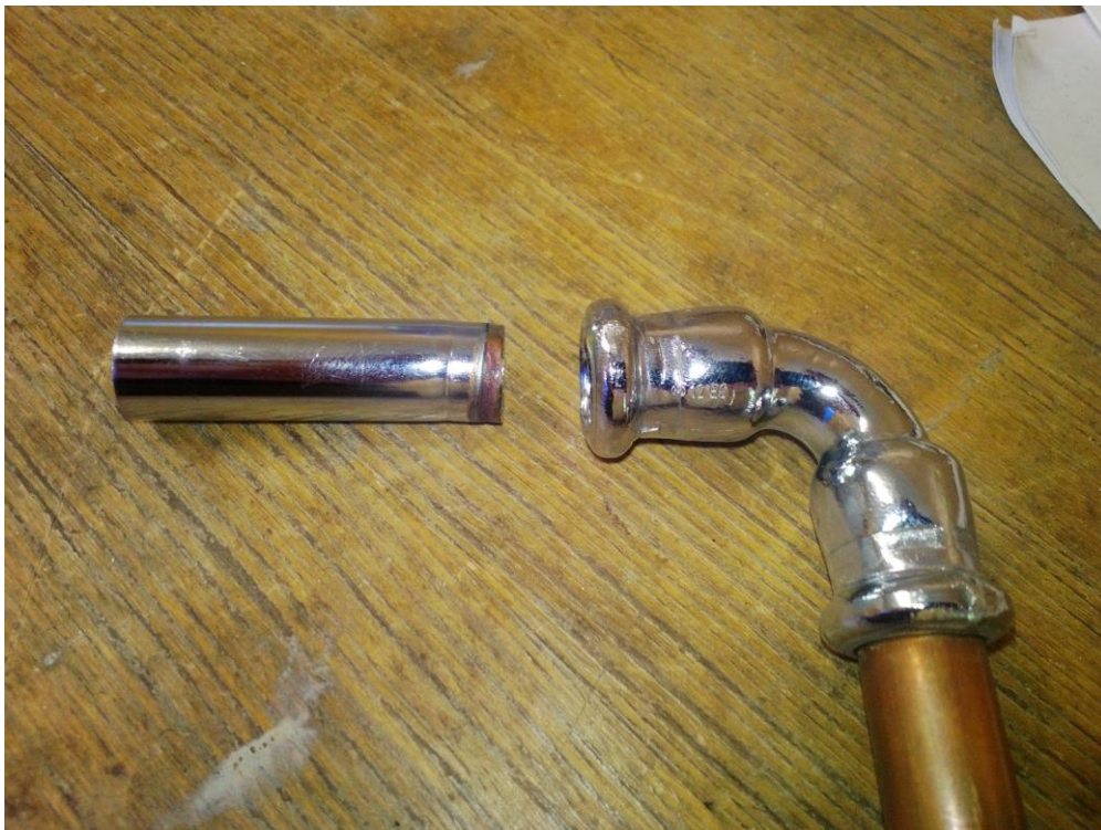
Kuva 6. Vesivahingon aiheuttanut puristusliitos.
