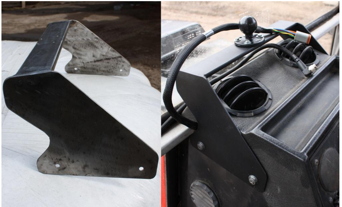
Kuva 7 Teline valmiiksi hitsattuna, sekä maalattuna ja kojelautaan asennettuna.
