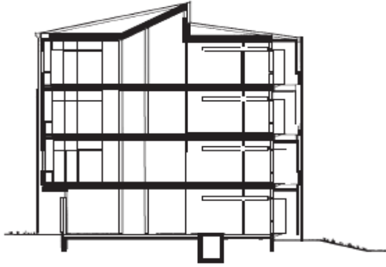
Kuvio 2. Paikallavaletun kerrostalon runkorakenne.
