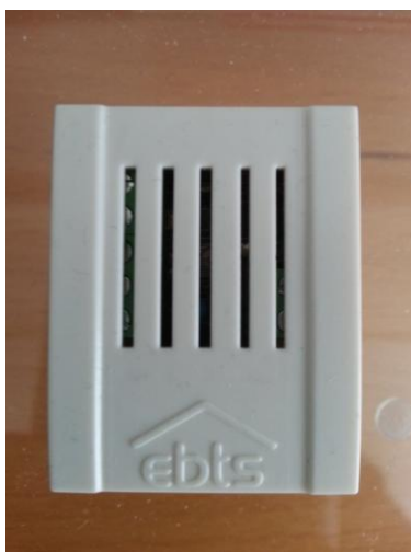
KUVA 14. Lämpötila- ja valoisuusanturi (Kuva: Kare Rantanen 2013)
