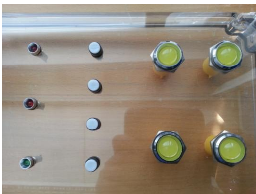
KUVA 15. Ledit ja painonapit (Kuva: Kare Rantanen 2013)
