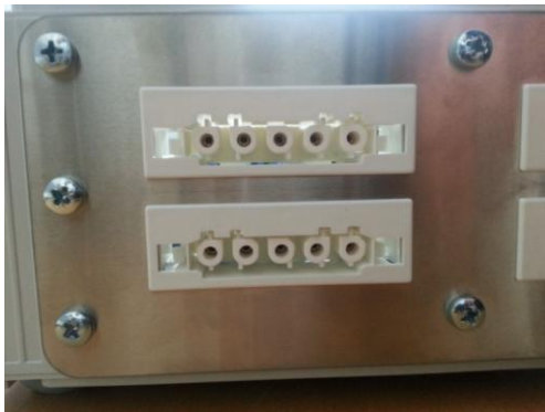
KUVA 2. EnstoNet-liittimet (Kuva: Kare Rantanen 2013)
