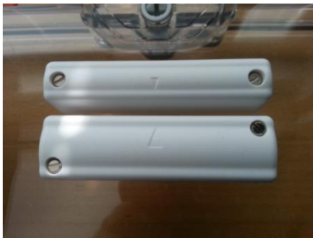
KUVA 12. Ovikytin (Kuva: Kare Rantanen 2013)
