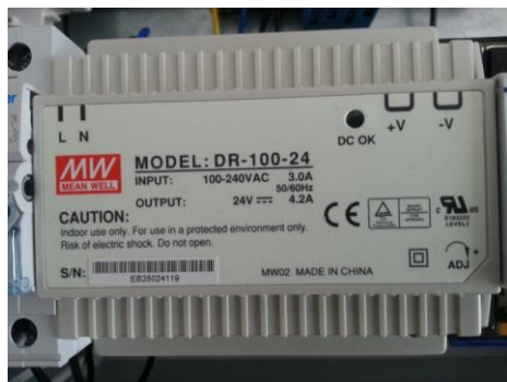
KUVA 10. Teholähde 24 V (Kuva: Kare Rantanen 2013)
