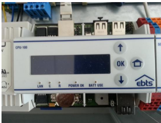
KUVA 4. Keskusyksikkö (Kuva: Kare Rantanen 2013)
