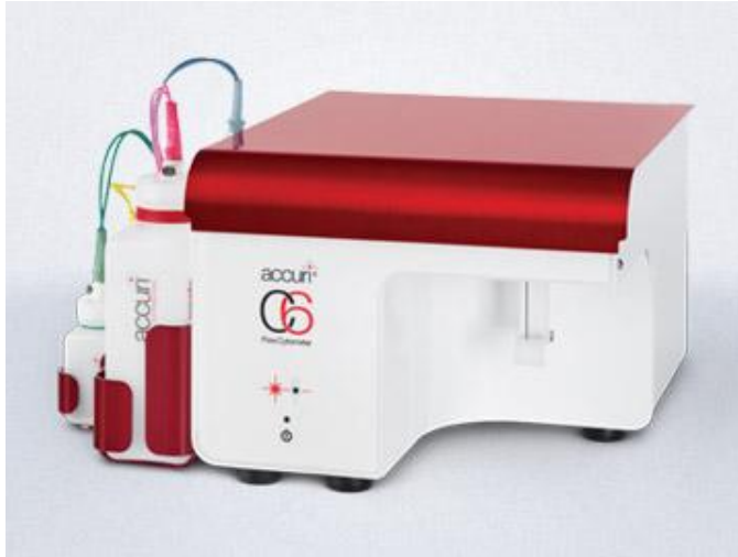
Kuva 1. Virtausytometrillä tutkitaan yksittäisiä näytepartikkeleita. Kuvassa BD Accuri C6 -sytometri (BD Accuri C6 2013).
