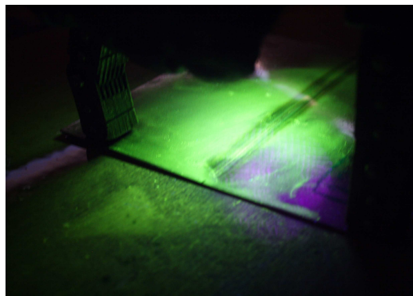
Kuva 4. MT-testaus fluoresoivalla menetelmällä
