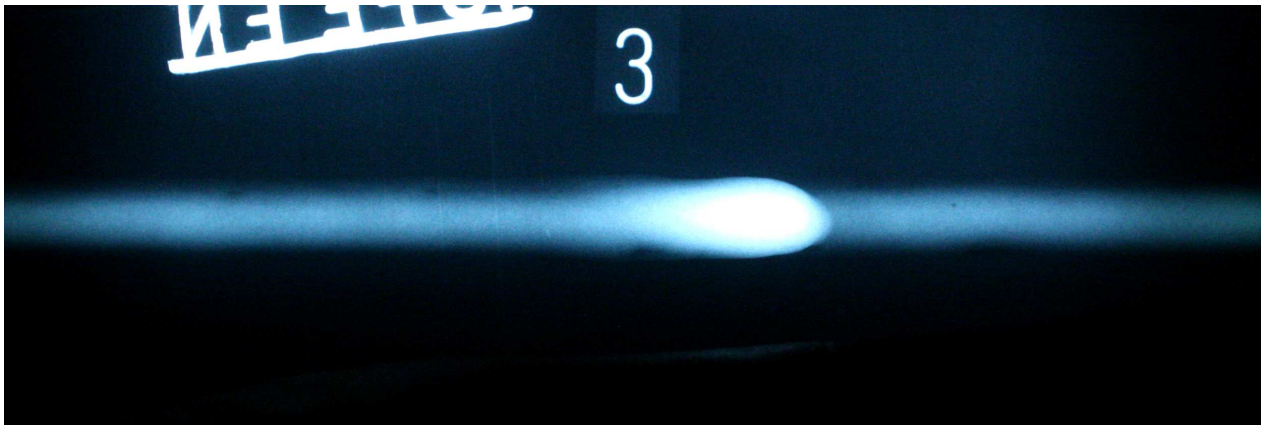
Kuva 3. Ylisuuri kupu antaa vaalean näyttämän RT-filmissä
