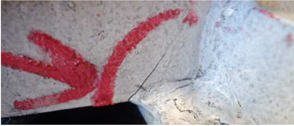
Kuva 3. Särö lähtenyt hitsipalon vierestä ja jatkunut perusaineeseen.
