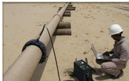
Kuva 9. Guided Wave käytössä. (International Inspection Centre W.L.L. Hakupäivä 13.04.2013)
