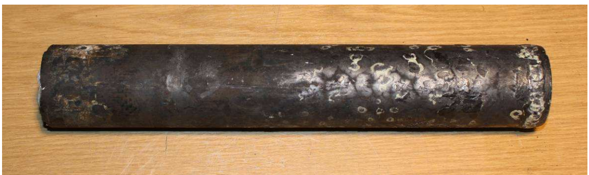
Kuva 17. Lämmönvaihtimen putki, pinta kerrostuman peitossa.
