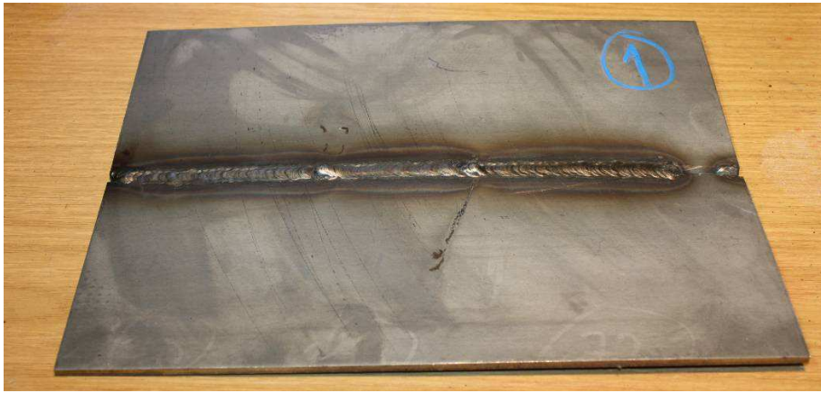
Kuva 12. Puikkohitsattu päittäishitsi V-railoon. Huomaa kolme erillistä hitsiä.
