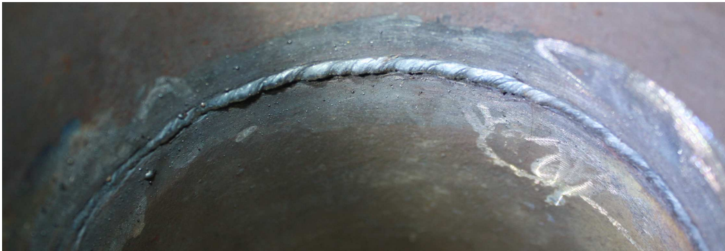
Kuva 4. Juurenpuoli. Roiskeita ja vajaata tunkeumaa
