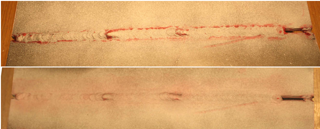
Kuva 3. PT-tarkastus ennen hiekkapuhallusta (yllä) ja hiekkapuhalluksen jälkeen (alla).
