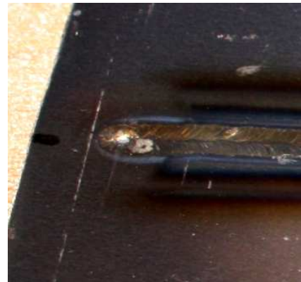
Kuva 2. Lopetuskohdan imuontelo, levy 11
