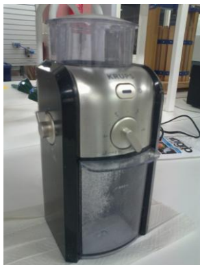
Kuva 8. Jyvä – ja hiutalenäytteiden jauhamiseen käytetty mylly.
