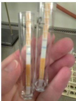
Kuva 7. Gluteenimäärityksen pikamenetelmän testitikut. Kuvassa nähtävissä kontrolliviiva eli ko. näyte ei sisällä gluteenia.
