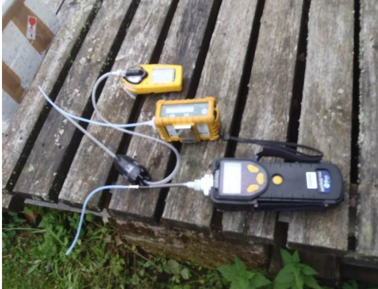
KUVIO 9. Asiantuntijaorganisaation ja opinnäytetyön maaperätutkimuksissa käytetyt PID-kenttälaitteet (ylimpänä Gas Alert Micro 5 PID, keskellä Multirae PGM-50 ja alimpana ppbrae 3000)
