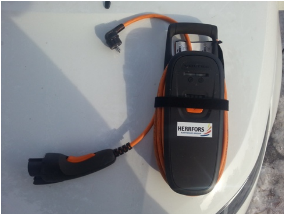
KUVIO 12. Opel Ampera 6-10A:n matkalatausasema Schuko-pistokkeella. Lataus- tapa 1.
