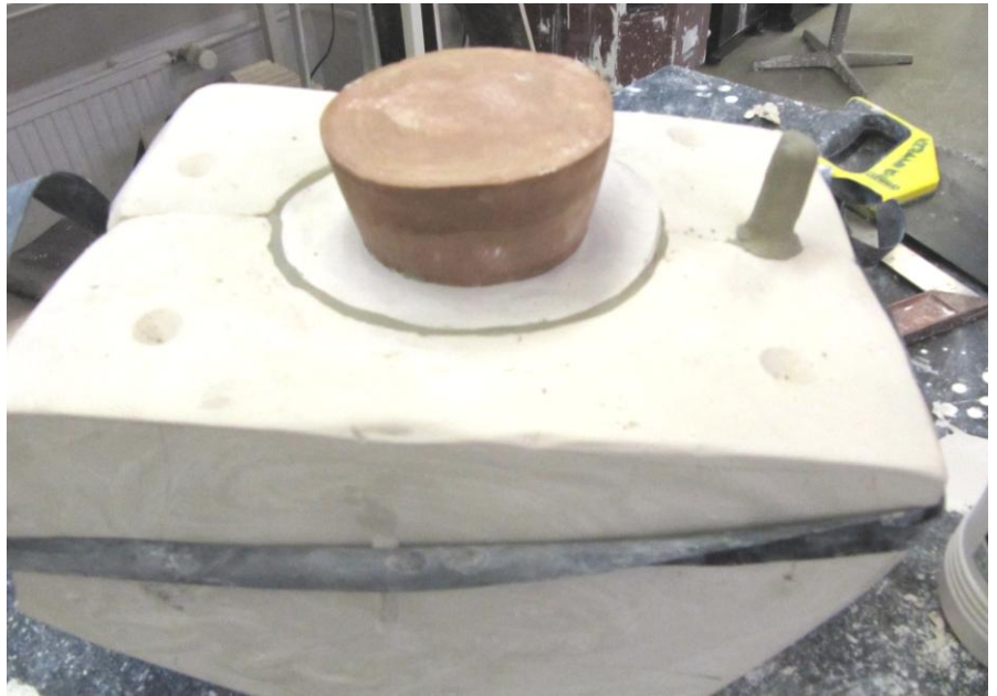
KUVA 38. Nokan valuaukko ja suuaukon osa valettuna ja viimeisteltynä.
