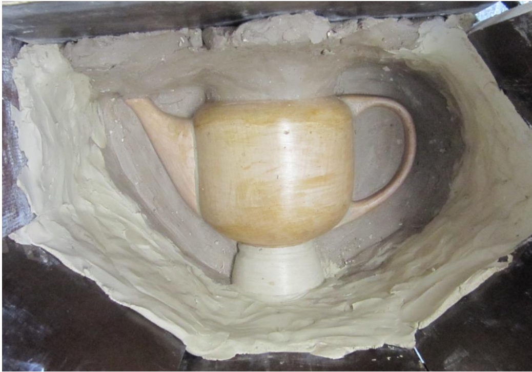
KUVA 35. Malli on valmisteltu apumuotin valamista varten.
