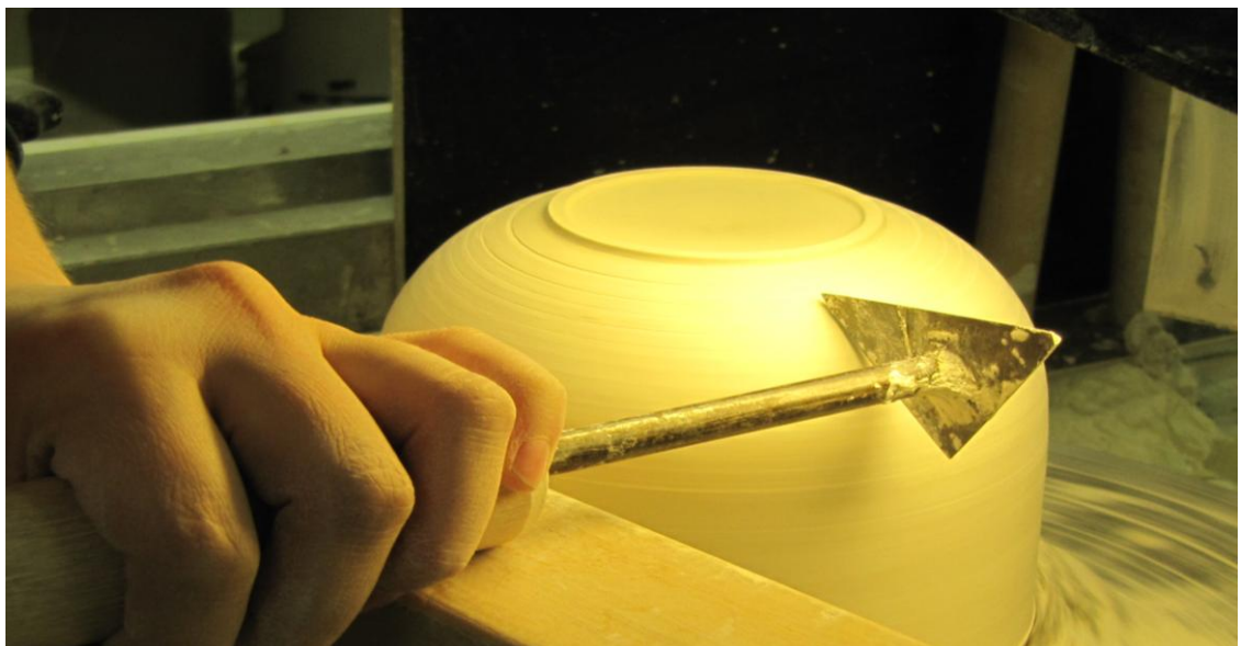
KUVA 16. Mallin sorvaus pyörähdyskappaleeksi urien avulla. Kuvassa näkyy myös alaspäin olevan mallin jalkarengas.
