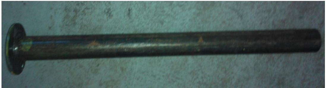
Kuva 11. Akselitappi, joka pitää rullan paikoillaan
