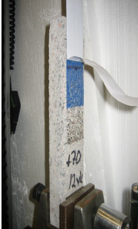
Kuva 13. Teipin testausta (peeling –veto) ( VTT-S-07025-10, 3)
