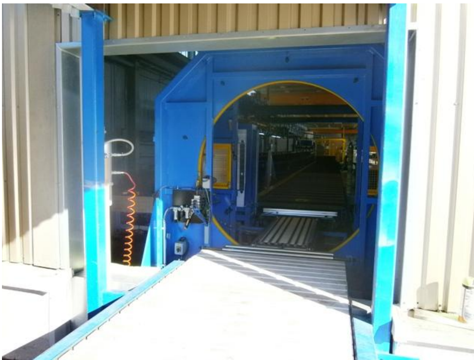
3. Valmiin seinälevyn kuljetin lastauslaiturille
