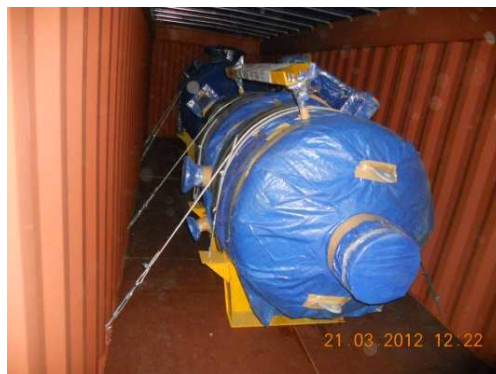
KUVAT 19 ja 20. Konttipakkauksia, joissa oli puutteellinen kiinnitys.
