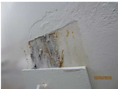
KUVAT 35 ja 36. Maalivaurioita maantiekuljetuksen aikana.
