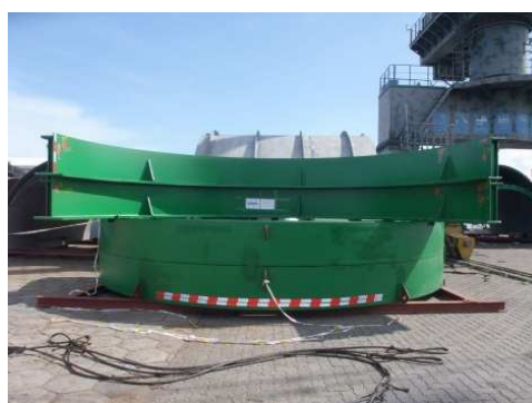
KUVAT 2 ja 3. Haihdutinyksikön vaippalohkoja ja kannatinrenkaita kuljetusalustoilla.
