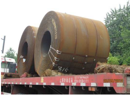
KUVAT 31 ja 32. Lasti ilman kiinnitystä.
