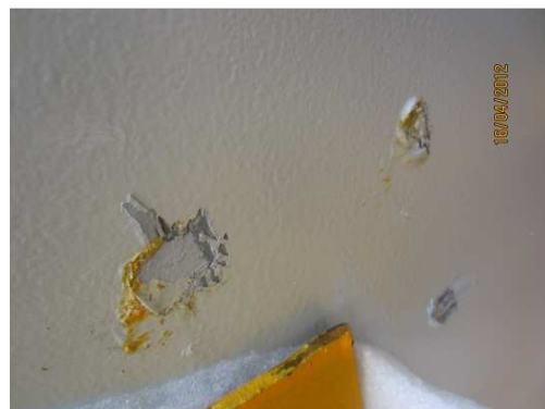
KUVAT 35 ja 36. Maalivaurioita maantiekuljetuksen aikana.
