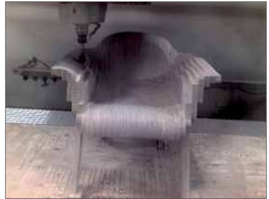
Tuolimallin jyrshintää 5-akselisella CNC-koneella. Kymi Design&Business 2012.
