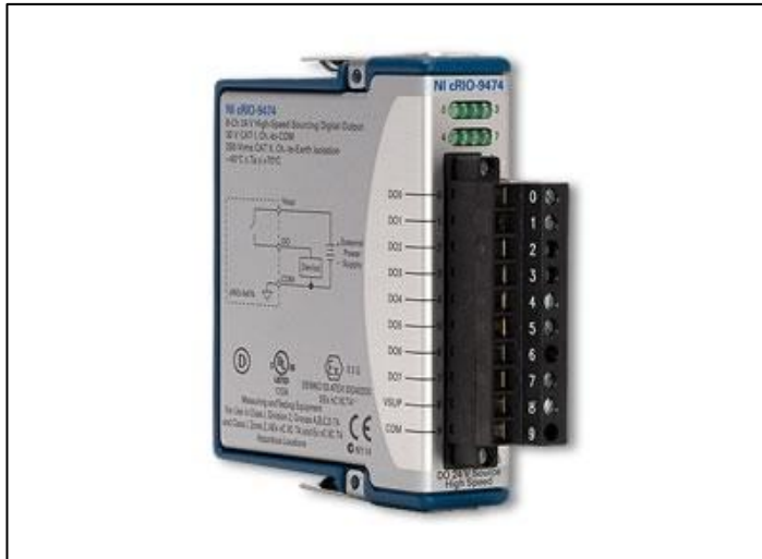
Kuva 12. National Instruments 9474 8-Channel Digital Output Module [10]
