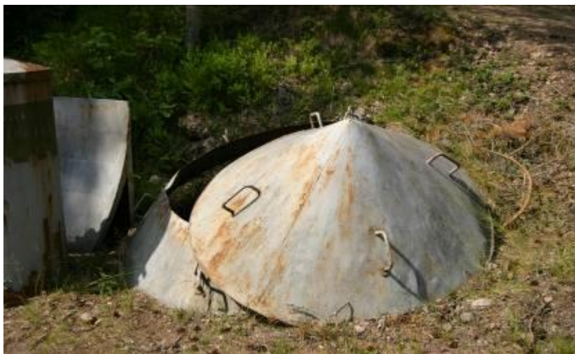
Kuva 21: Muottikalustoa, alamuotti ja valukartio, Salpamuseo Miehikkälä, Kaikkonen 2011
