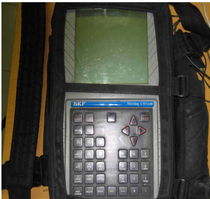
Kuva 10. Microlog CMVA 60-analysaattori. Kuvan analysaattorilla suoritettiin kaikki värähtely- mittaukset.
