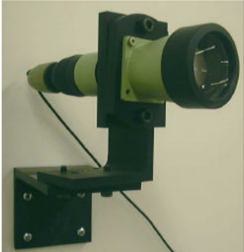
Kuva 6. Seinälle kiinnitetty kollimaattori. Kuvassa on nähtävissä johto, jolla saadaan virta kaukoputken päässä olevalle valonlähteelle. [6]
