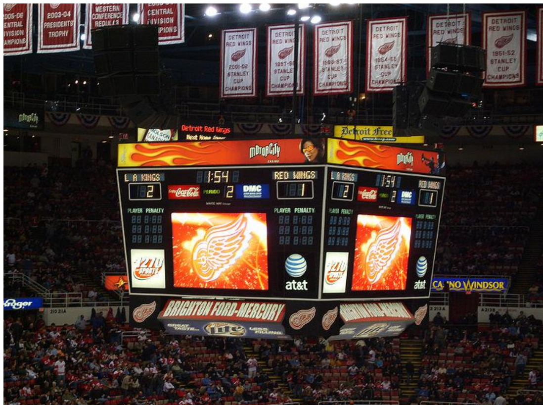
Kuva 4. Mediakuutio koostuu tulostauluista, näytöistä sekä äänentoistolaitteista.
