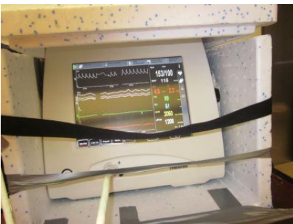
KUVA 9. Nexfin mittaamassa jatkuvaa verenpainetta sormenpäältä altistuksen aikana
