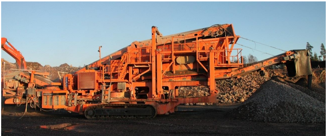
Kuvio 6. Track-mallinen jälkimurskain varustettuna kaksitasoseulalla
