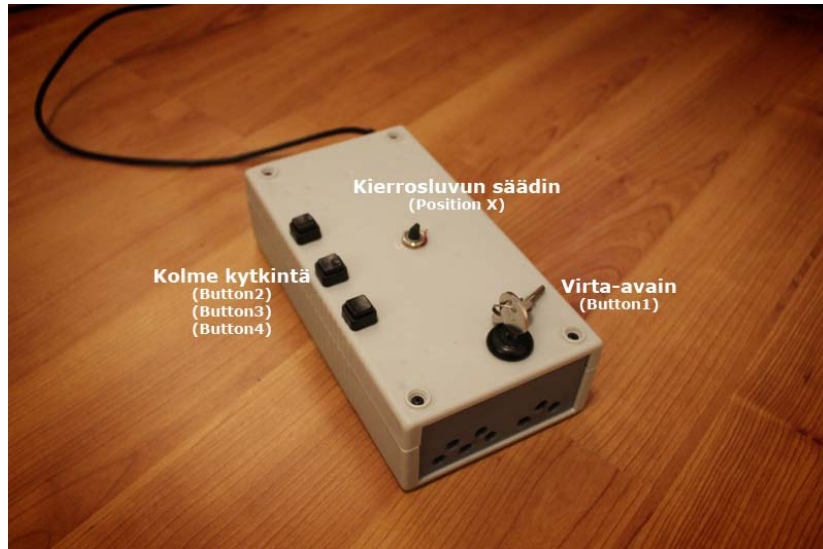
KUVA 28. Ohjainlaatikon (ns. kojelauta) käyttöliittymä (Viljanen 2012)
