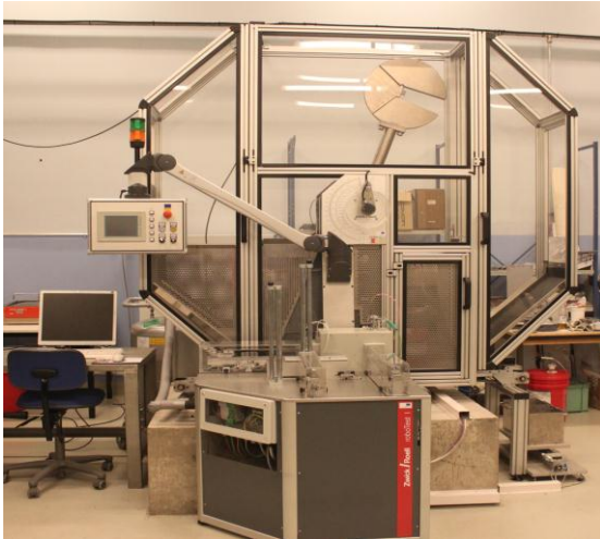
Kuva 4. Zwick Roell PSW750 instrumentoitu iskuvasara KTAMK:n tutkimuslaboratoriossa
