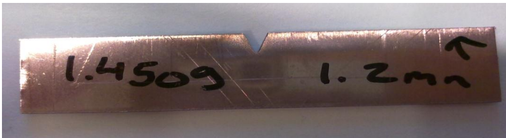
Kuva 3. Perusaineen iskusauva (Kalliosalo 24.2.2012, sähköpostiviesti)
