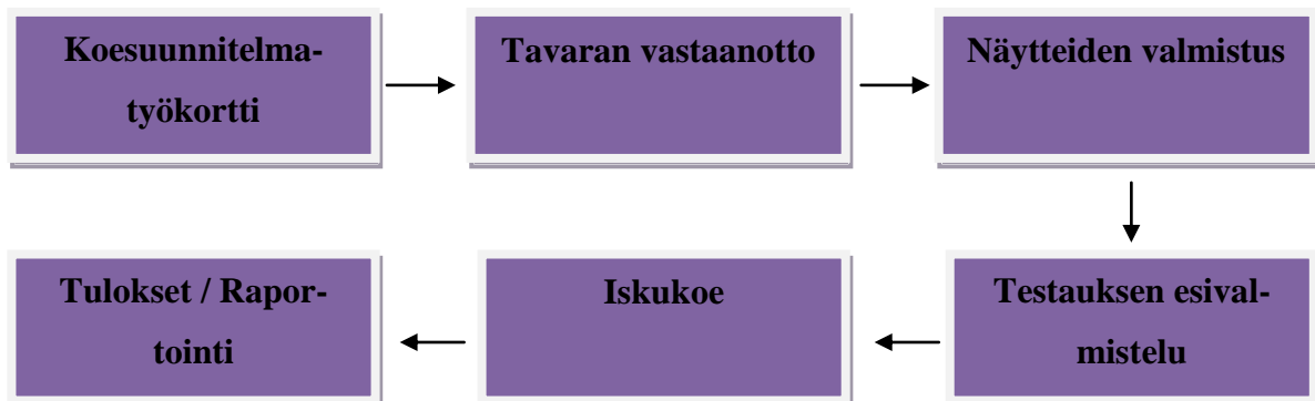
Kuvio 3. Iskukokeen työprosessi KTAMK:n tekniikan TKI-yksikössä
