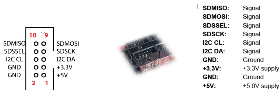
KUVA 15. Laajennusliittimen nasta järjestys /1/
