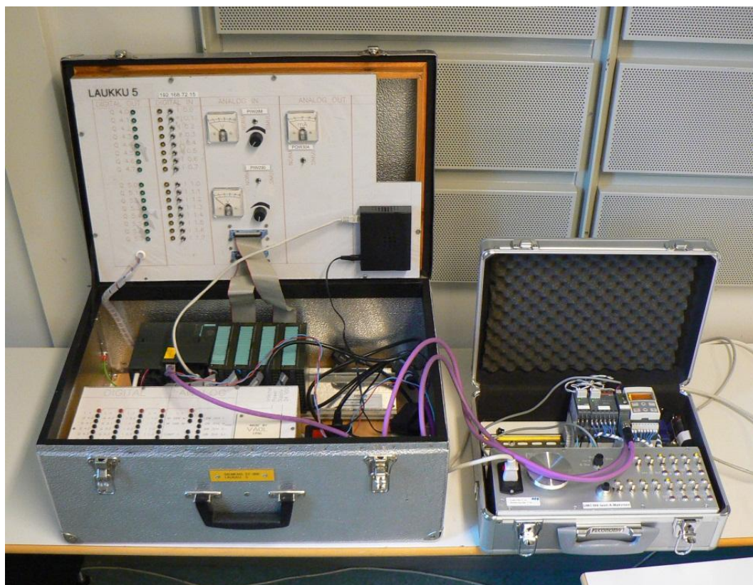
Kuvio 29. S7-kokoonpano ja UMC100-demolaitteisto. /9./
