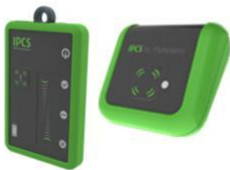
KUVA 10. Vasemmalla ID-tag ja oikealla Asset-tag (20.)
