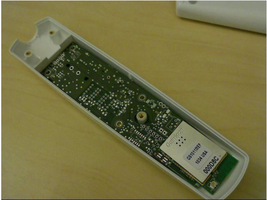
KUVA 14. Delfin Technologies Oy:n mittalaite ja GainSpan GS1011M -moduuli sovitettuna laitteen kotelon sisälle
