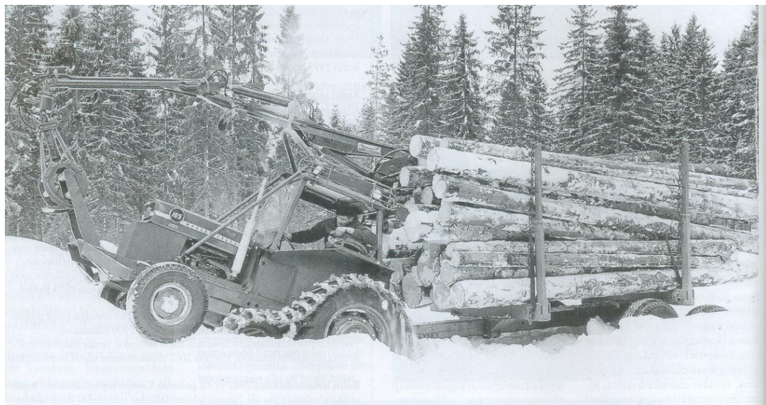
KUVIO 3. MF-MiniRobur varustettuna Cranab-kuormaimella ja puoliteloilla (Kotta 2008, 88)
