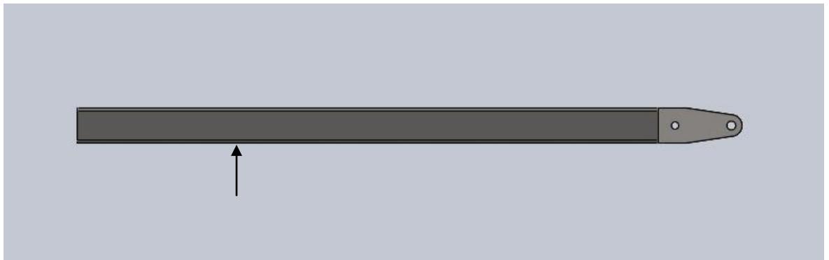
KUVIO 9. Jatkopuomin 3D-malli ja lujuustarkastelun kohta
