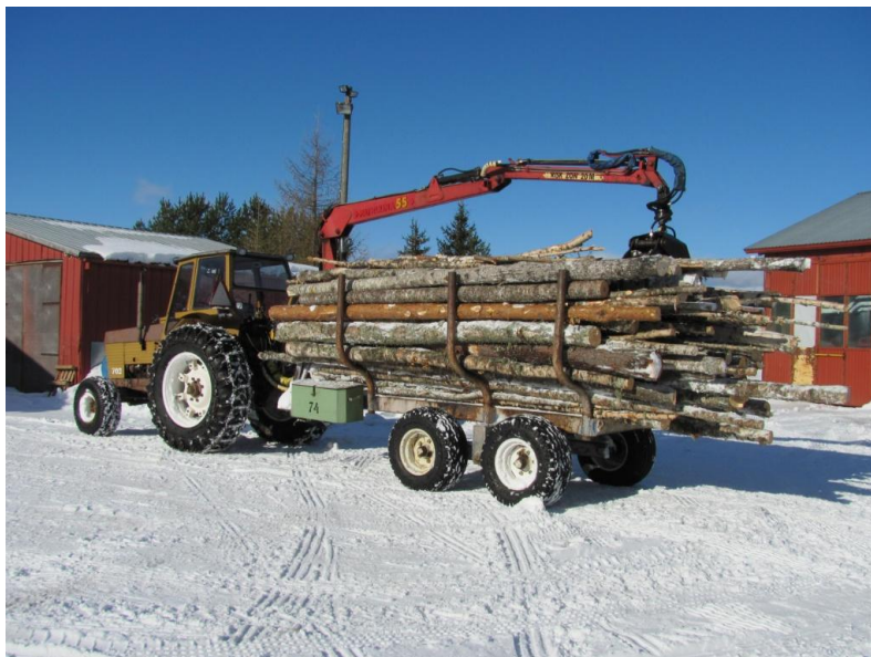
KUVIO 4. Nykyaikainen kourakuormain-metsäperävaunu- yhdistelmä (kuvan ottanut Paavo Jyrkkä)
