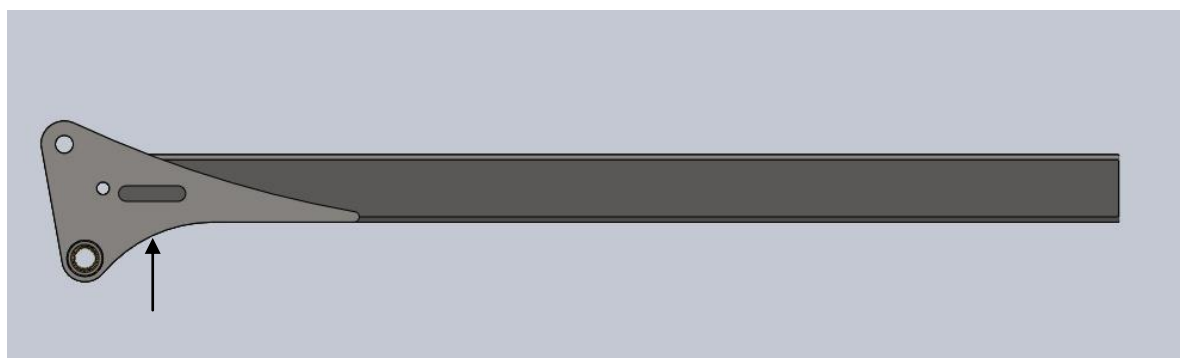
KUVIO 7. Taittopuomin 3D-malli ja lujuustarkastelun kohta
