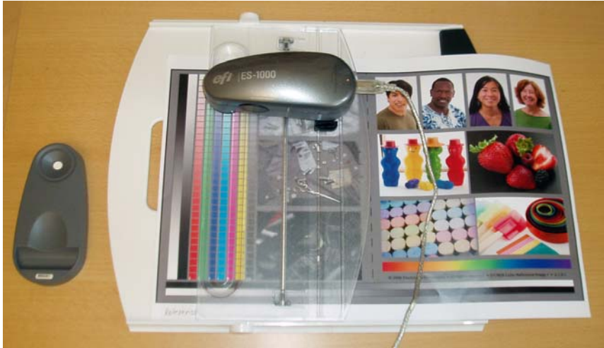
Kuva 3. Värimittaus EFI ES-1000 –spektrofotometrillä.
