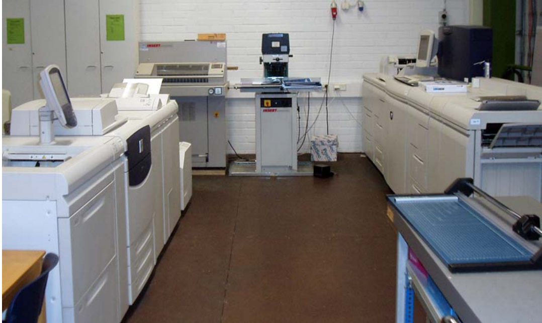
Kuva 1. Oikeassa reunassa on Xerox 700 -painokone, vasemmassa reunassa Nuvera 120 ja seinustalla näkyvät Eba 500 -giljotiinileikkuri ja Nagel Citoborma 280 -paperipora.
