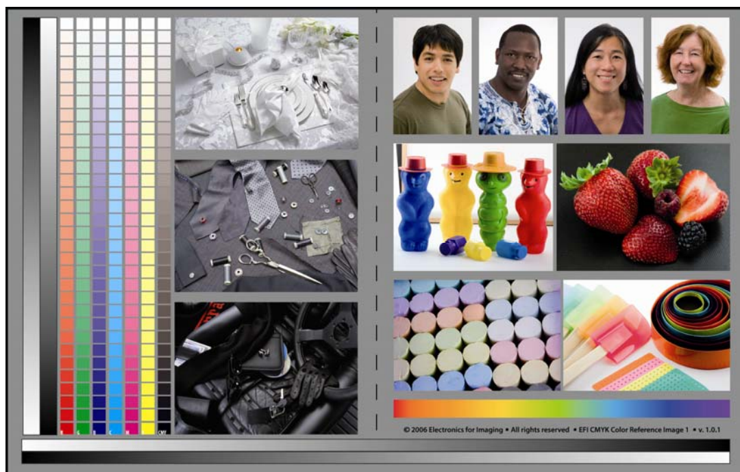
Kuvio 2. \Delta E -mittauksissa käytetty CMYK-testiarkki.
