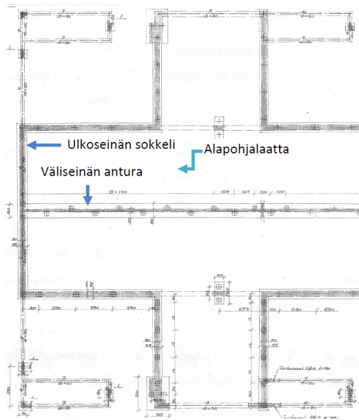
Kuvio 19. Betonin lujuuden ja suojabetonipaksuuden mittauskohdat.
