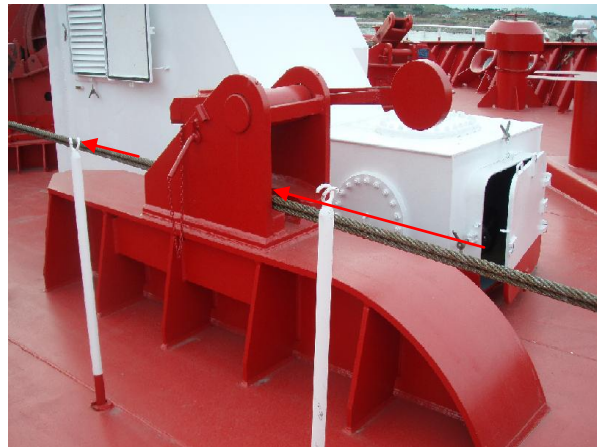
Kuva 6. Keulan hätähinausketjun lukitussalpa, Neste Shippingin laivaryhmäkohtainen ohje
