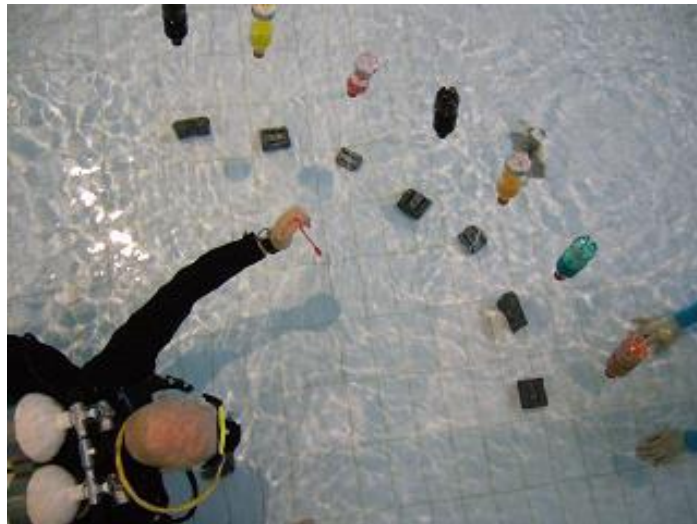
KUVIO 11. Horisontaalisen näkökentän mittaus vedessä.
