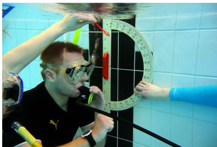
KUVIO 10. Vertikaalisen näkökentän mittaus vedessä (Kuva: Seppo Sirviö 2010).
