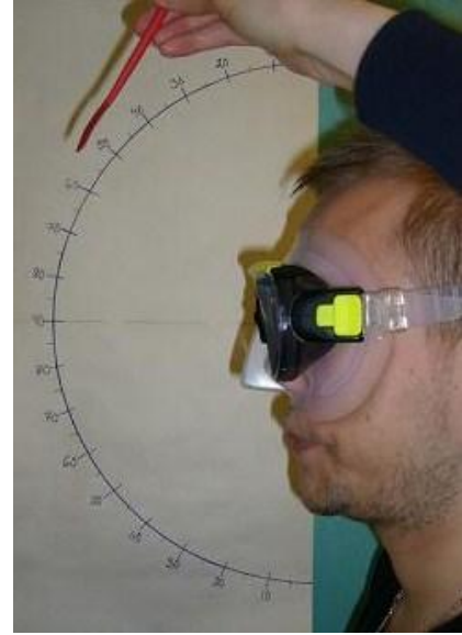
KUVIO 9. Vertikaalisen näkökentän mittaus pinnalla.
