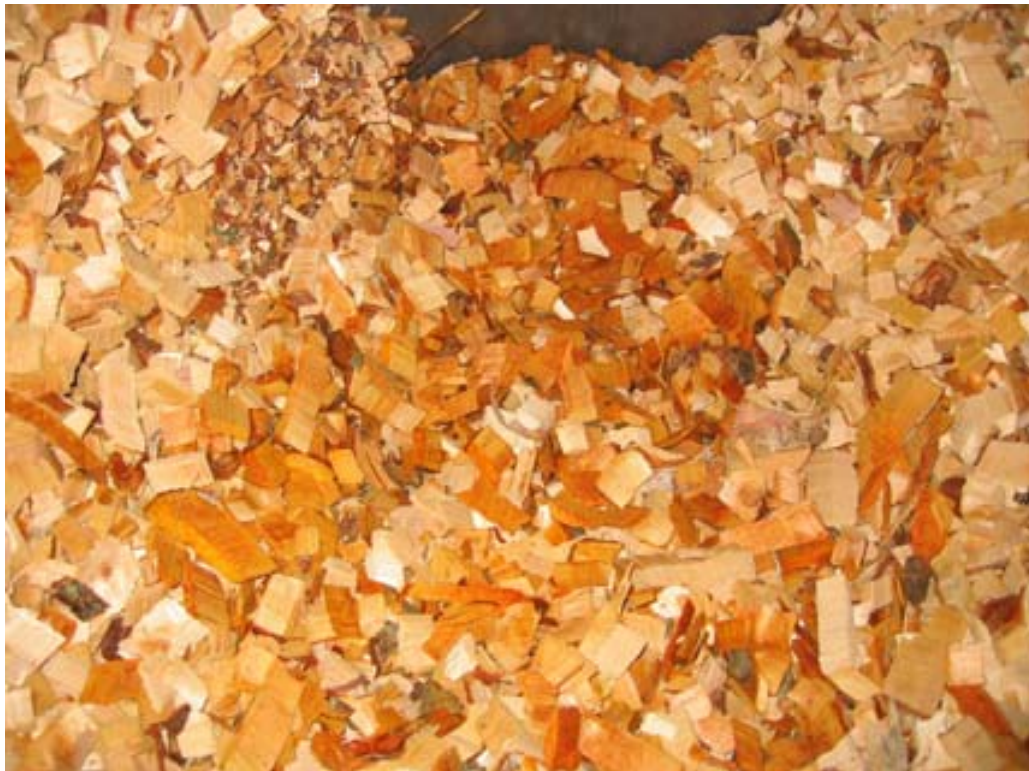
KUVIO 8. Kuivauksen aikana keskikerrokseen muodostunutta märkäkerrosta.
