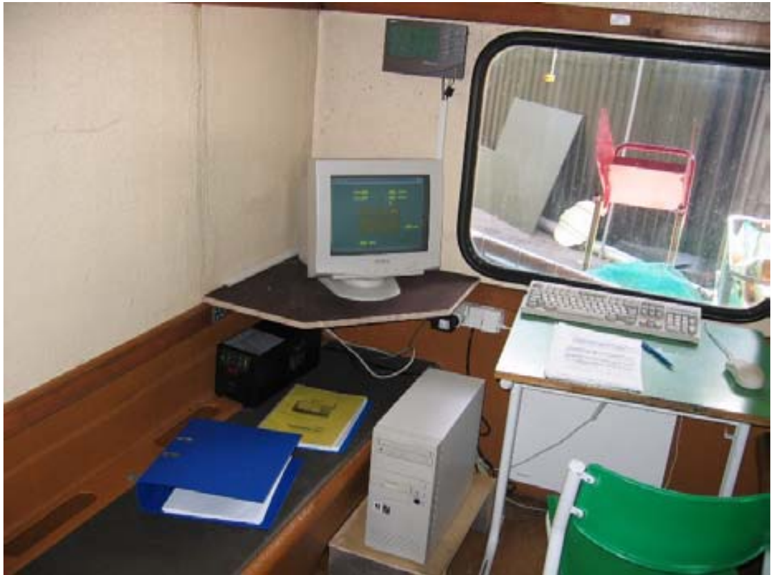
KUVIO 6. Kuvaa valvomosta, takaseinällä sääaseman näyttötaulu ja ruudulla kuivumisen prosessikaavio.
