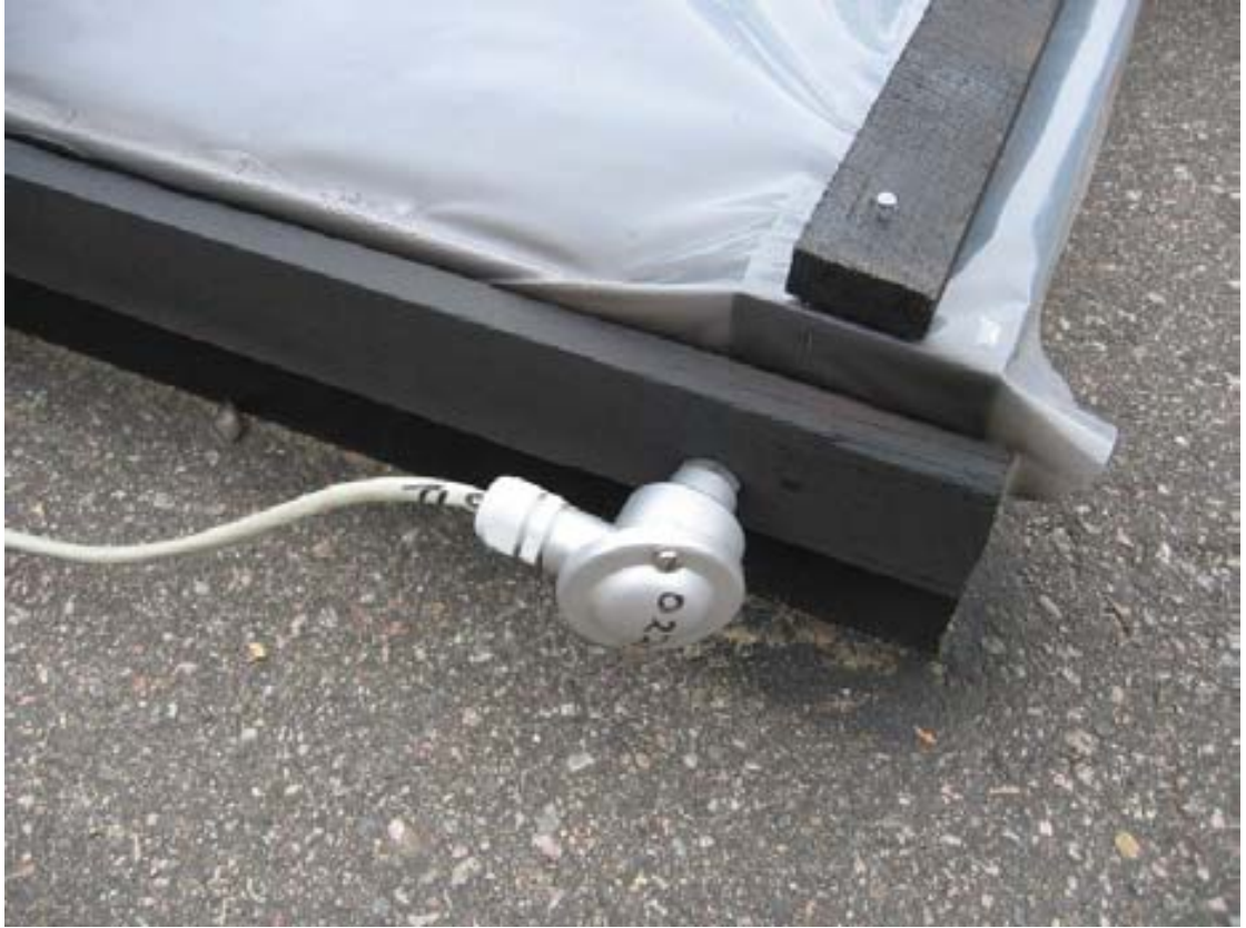
KUVIO 12. Lämpötilan asfaltin pinnasta mittaava anturi.
