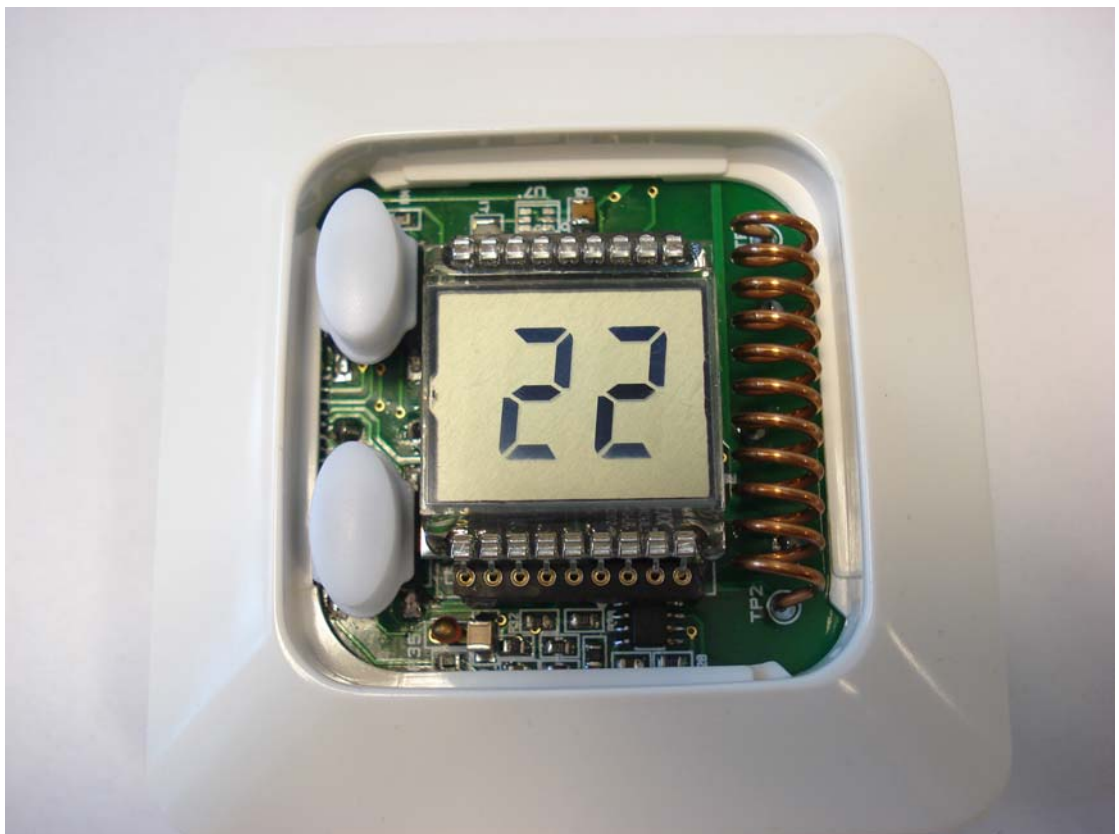
KUVA 27. Valmis lähetin ilman kantta.
