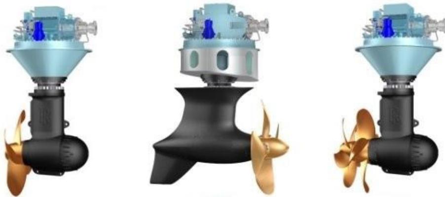
Kuva 4. Aquamaster potkurilaitteita eri potkuri vaihtoehdoilla/3/.
