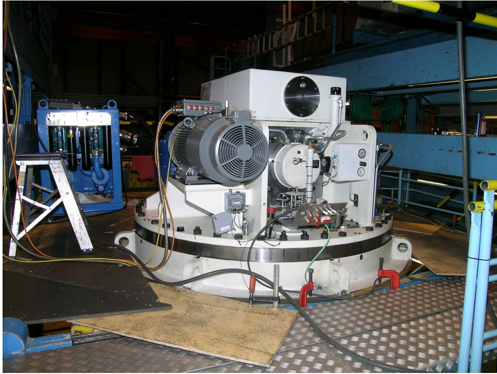
Kuva 5. Sähkökäännöllä varustettu potkurilaite koejaossa Rauman tuotantohallissa.
