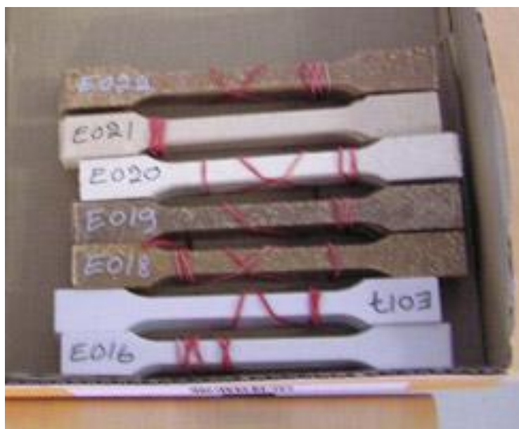
Kuva 6. VTT:n testaamia vetosauvoja (Myllymaa & Vestebacka 2005).
