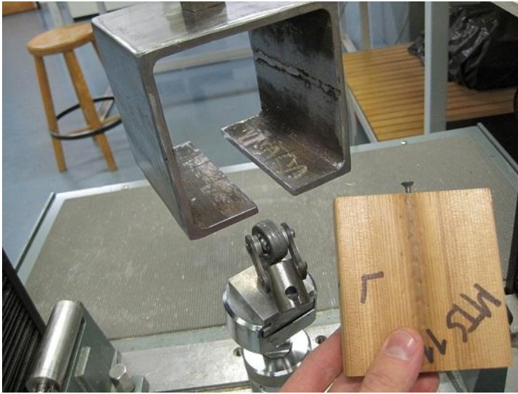
Kuva 3 Koekappaleen asettaminen vetoaihioon
