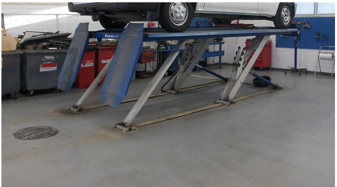
Kuvio 9. Nordlift UC-3500 siltanosturi.
