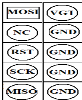
KUVIO 8. ISP kymmenen nastan liitin liitännät: STK500,-200,-300 ja AVR ISP:n liitäntäjärjestyksessä.
