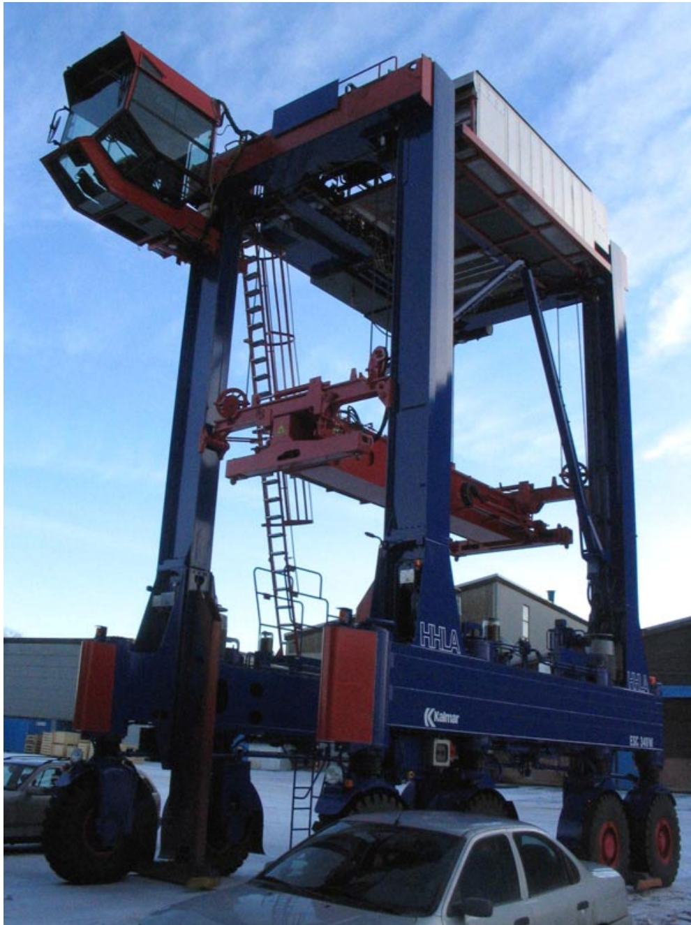
Kuva 1 ESC 340 W -konttilukki valmiina koeajoon Rauman satamassa
