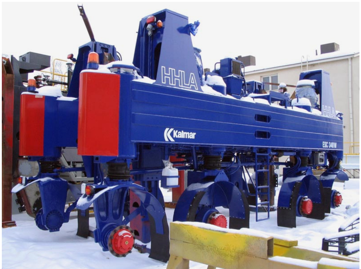
Kuva 2 Sivurunkopari valmiina lastausta varten
