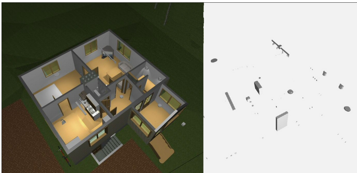
Kuva 15 ArchiCAD:llä avattu IFC-tiedosto (oik.) joka on liitetty talon pohjakuvaan ja visualisoitu valoilla (vas.)
