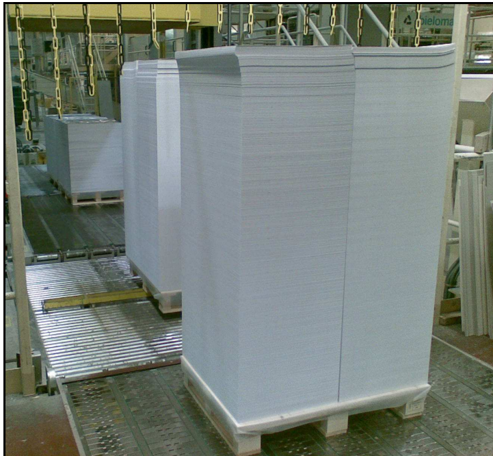
Kuvio 30. Kuljettimien aiheuttamaa riisien liikkumista
