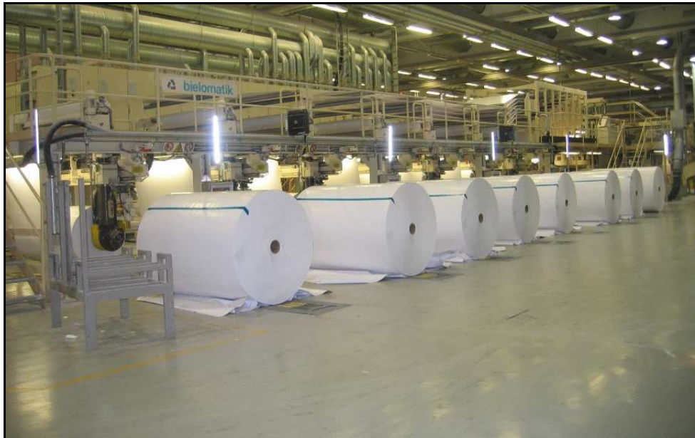
Kuvio 1. Arkkileikkurin aukirullaus ja uuden lastin valmistellut rullat.
