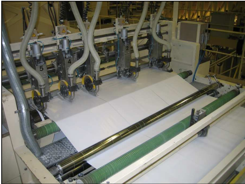
Kuvio 2. Arkkileikkurin yläpuolisten ratojen pituusleikkaus.
