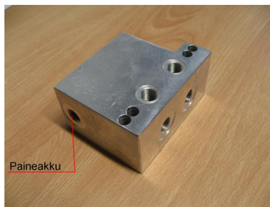
Kuva 14. Keskimmäinen venttiililohko, kalvopainevaraajan liitäntä
