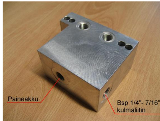
Kuva 17. Ylin venttiililohko, kalvopainevaraajan- ja kulmaliittimen liitännät
