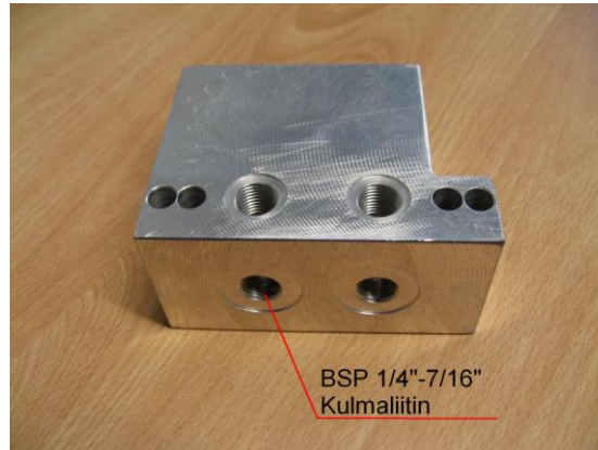
Kuva 13. Keskimmäinen venttiililohko, Jic -kulmaliittimen paikka
