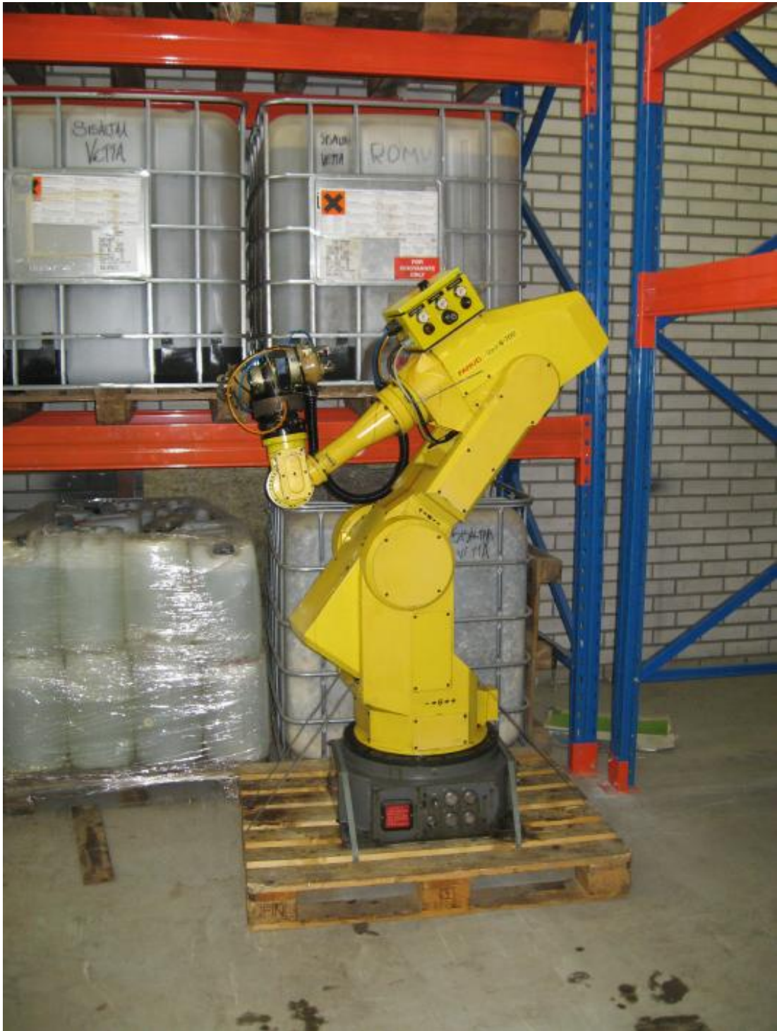
Kuva 3. Harjoitukseen käytettävän robotti Fanuc S-700.
