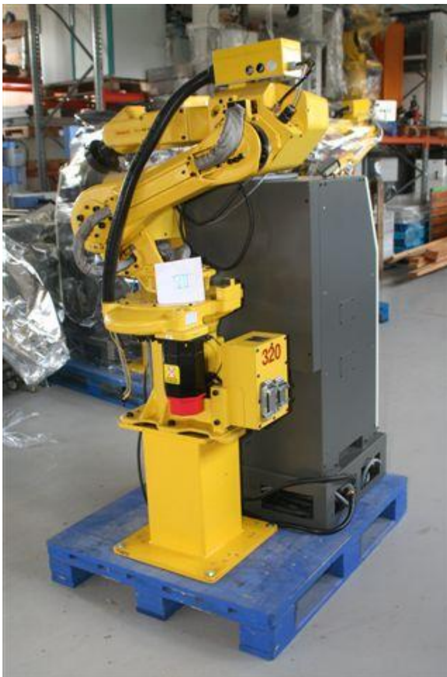
Kuva 6. Ohjausharjoituksiin, käsiohjaukseen ja robotin turvallistamiseen tarkoitettu koulutusrobotti.
