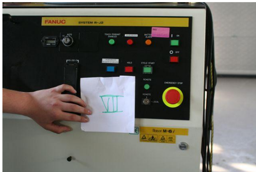
Kuva 7. Ohjausharjoituksiin, käsiohjaukseen ja robotin turvallistamiseen tarkoitettu koulutusrobotin ohjausjärjestelmä.
