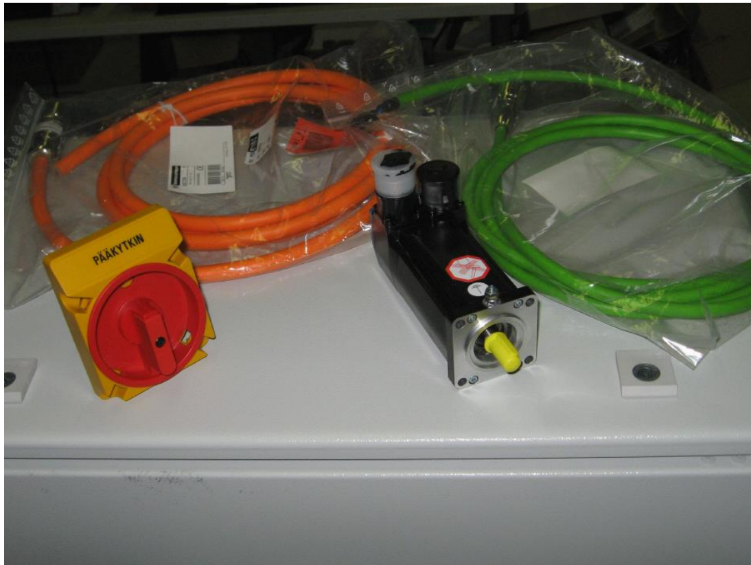
Kuva 2. Harjoitustyönä koottava Telemecaniquen yksiakselisen servojärjestelmän toimilaitteet ja kaapelit.
